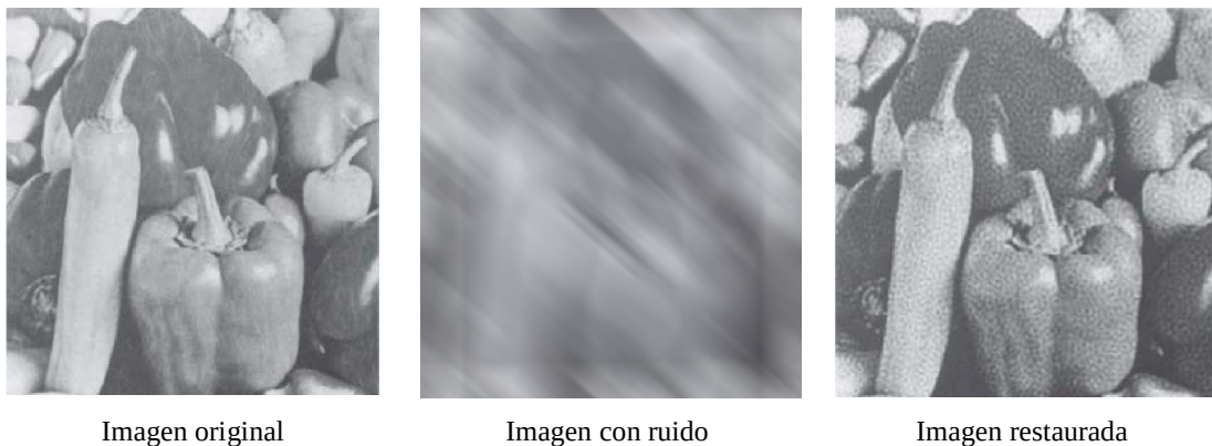
Figura 3.21. Ejemplo de la restauración de una imagen digital usando filtro inverso (Pratt 2007).
