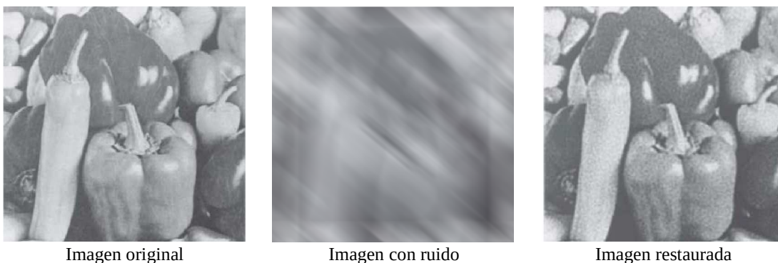
Figura 3.20. Ejemplo de la restauración de una imagen digital usando filtro Wiener (Pratt 2007).
