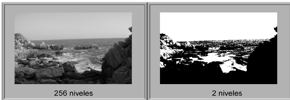
Figura 3.7. Ejemplos de los efectos de la cuantificación (Somolinos 2002).
