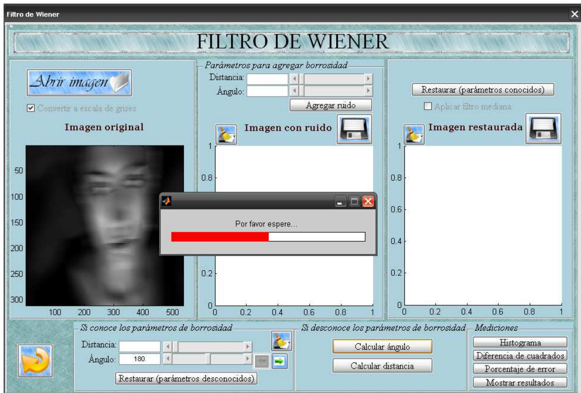
Figura A.16. Visualización del cálculo del ángulo para una imagen borrosa.
